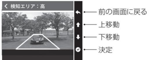
**【質問】** 検知エリアを示す枠線の中に入った車両を検知します。高速（約100km/h）で走行中に、後方車両がどの距離まで接近したら検知するかを設定してください。低～中速走行時の検知エリアは自動的に調整されます。
