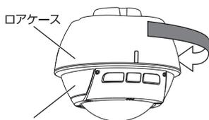
2. カメラのボタン部とアッパーケースのボタン部を合わせてセットし(①)、その上からロアケースをかぶせます(②)。
