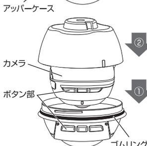
3. アッパーケースを押さながらロアケースを時計回りに回して締付けます。ボタン部の反対側についてはガイド(細長い凸部)を確認し、ガイド①とガイド②の位置が合っていれば装着完了です。
